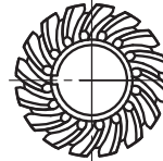
bogenverzahntes Kegelrad Typ R (Rechts)
